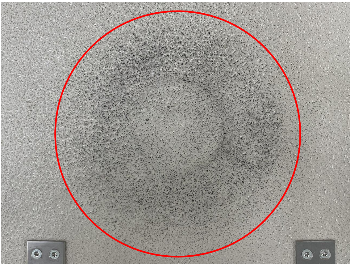
Abbildung 20: Messstelle des Probekörpers 2 nach 15.000 Zyklen; Verschleißbereich gereinigt (Kreis)
