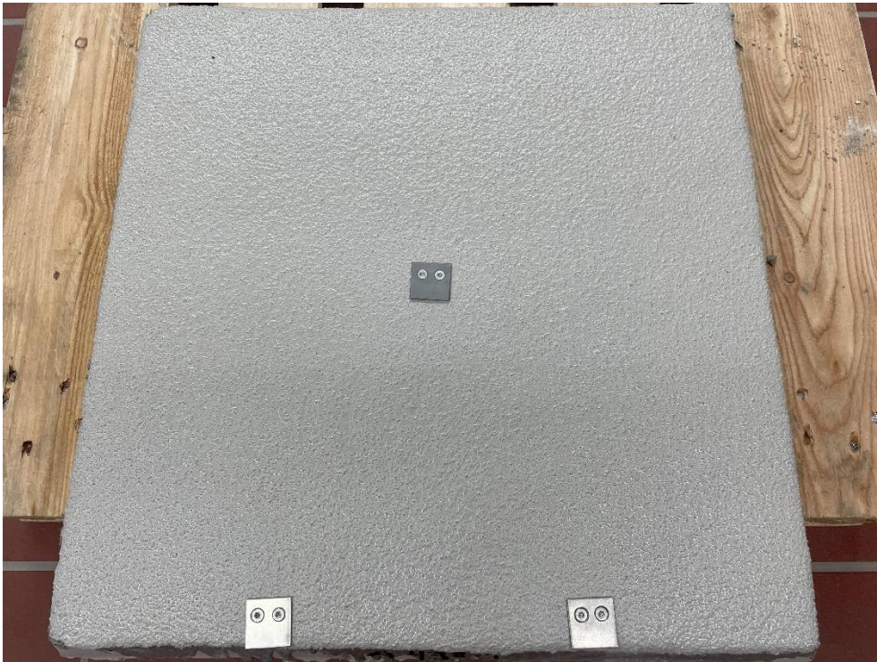
Abbildung 2: Beschichteter Prüfkörper 1 mit Referenzplättchen für Lasermessung
