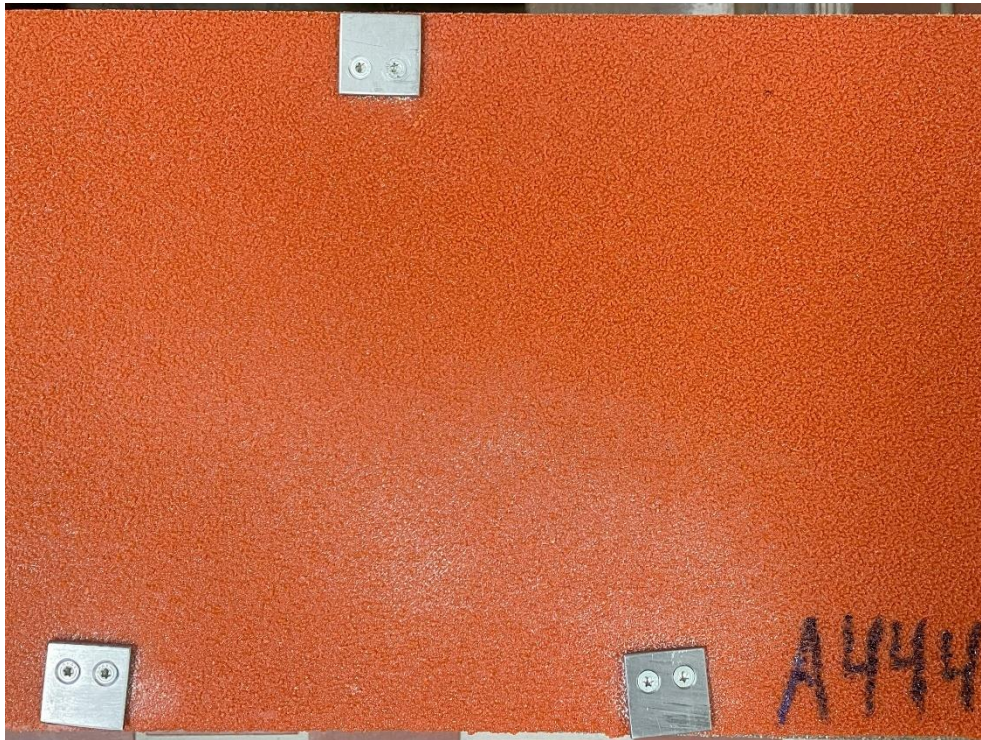
Abbildung 2: Beschichteter Prüfkörper 1 mit Referenzplättchen für Lasermessung
