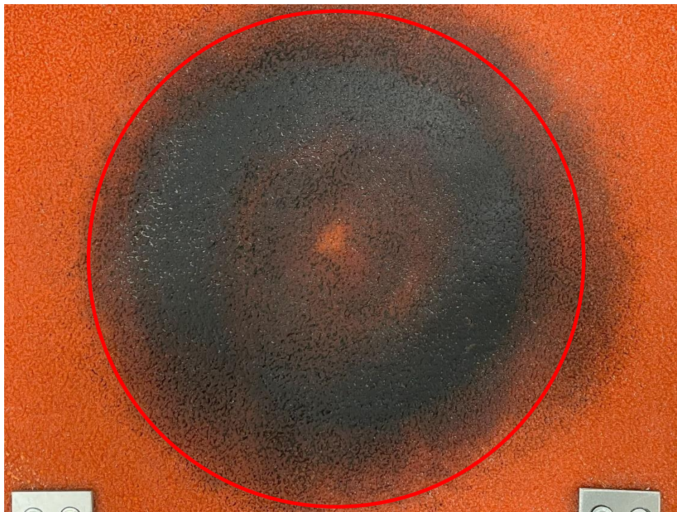
Abbildung 20: Messstelle des Probekörpers 2 nach 120.000 Zyklen; Verschleißbereich gereinigt
