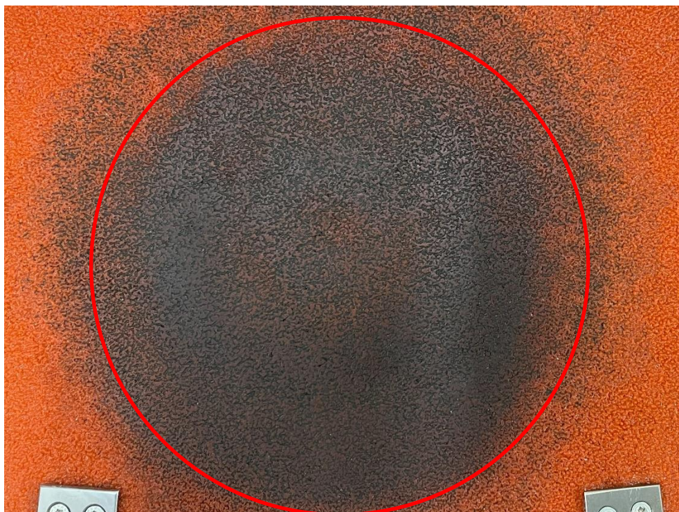
Abbildung 18: Messstelle des Probekörpers 1 nach 120.000 Zyklen; Verschleißbereich gereinigt
