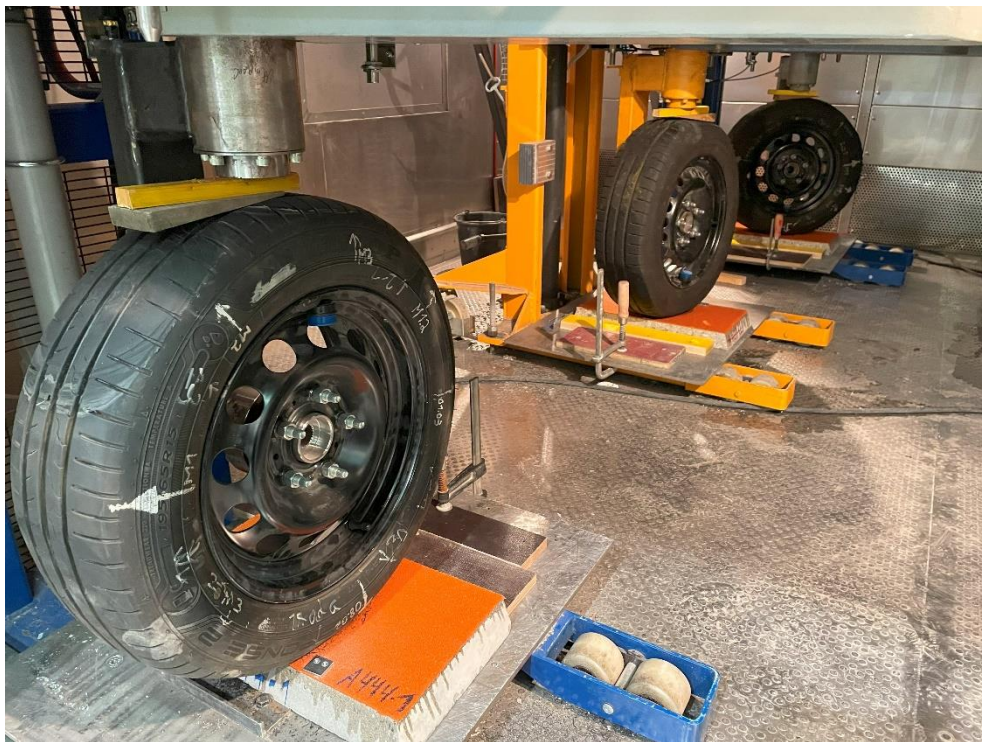
Abbildung 3: Versuchsaufbau Parking Abrasion Test, drei PAT-Prüfstände in klimatisierter Umgebung (Klimakammer mit 23 °C/50 % rel. Feuchte)
