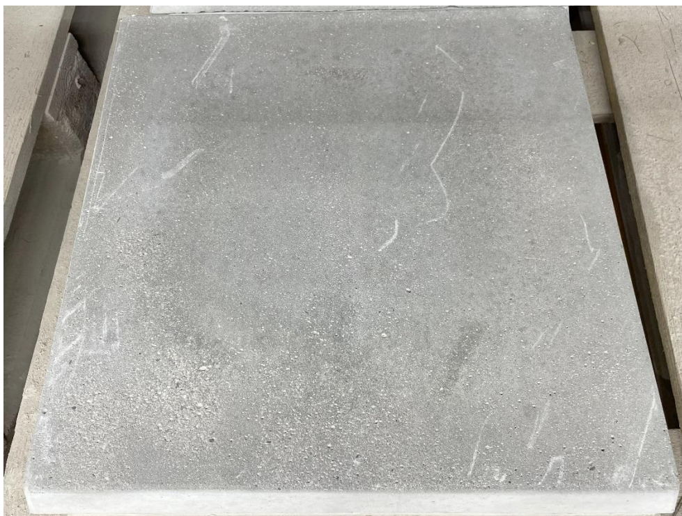
Abbildung 1: Quadratischer Betongrundkörper, sandgestrahlt
