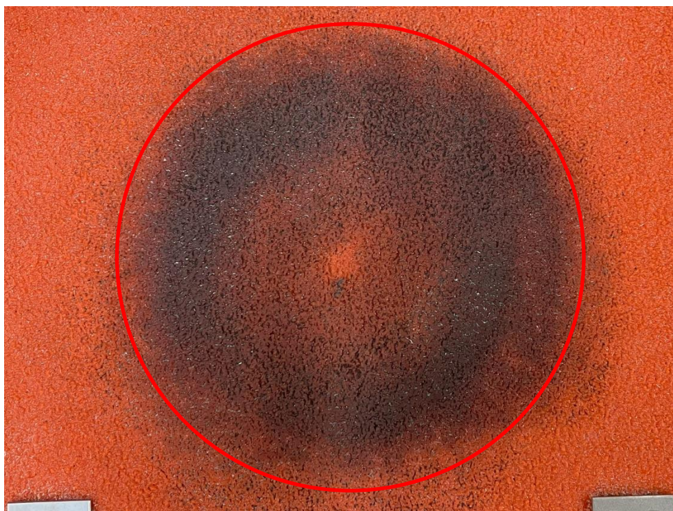
Abbildung 22: Messstelle des Probekörpers 3 nach 120.000 Zyklen; Verschleißbereich gereinigt
